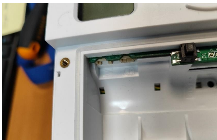
Рисунок 6. Разъемы для элементов питания в счетчике типоразмеров G1,6; G2,5; G4; G6 «К» исполнения И1, И3
