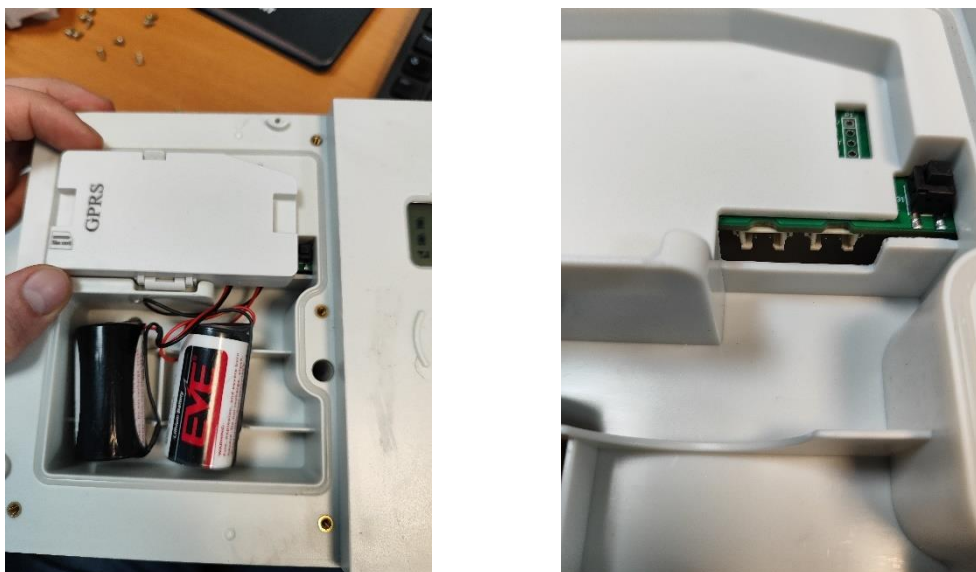
Рисунок 7. Разъемы для элементов питания в счетчике типоразмера G6 «Б»; G10 исполнение И1
