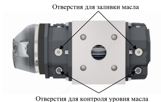
Рисунок 13 – Заливка и контроль уровня масла при установке счетчиков G16 - G400 DN100 на горизонтальном участке трубопровода
