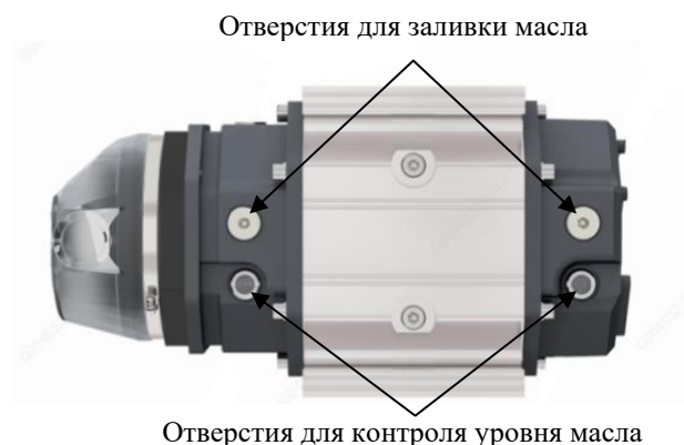
Рисунок 14 – Заливка и контроль уровня масла при установке счетчиков G16-G400 DN100 на вертикальном участке трубопровода
