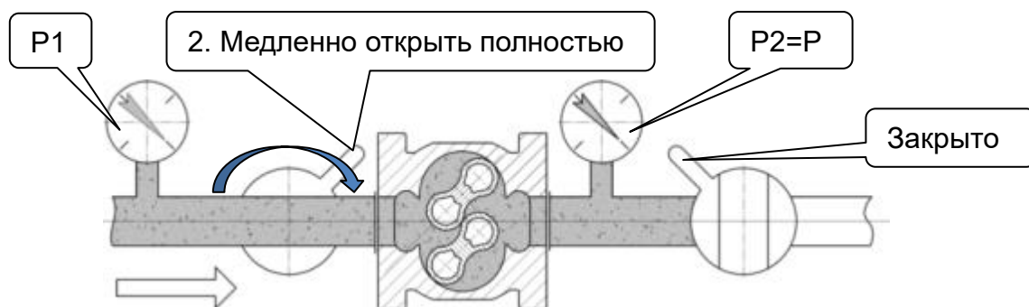
Рисунок 12. Полное открытие запорного устройства до счетчика
